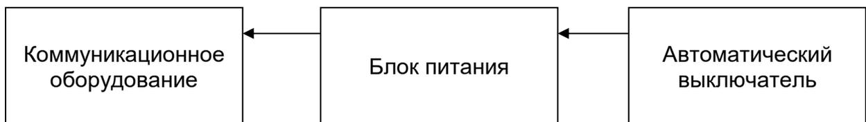
Рисунок 1.2 – Общая структурная схема ШР
